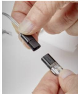
El motor de luz puede ser reemplazado sin esfuerzo en unos pocos pasos. La conexión eléctrica se desconecta fácilmente utilizando el práctico conector plug-and-play.
