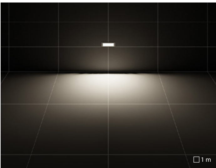
A25/W óptica asimétrica difusora
