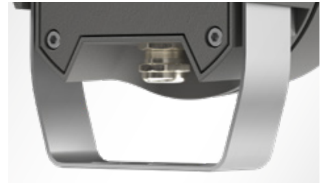
Presse étoupe à amarrage en laiton nickelé M20x1.5 pour câbles Ø 10 mm à Ø 14 mm
