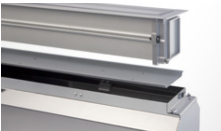
Elke inbouw-montageset is voorzien van een beschermende kap om vervormingen tijdens het installeren en betongieten te voorkomen.
