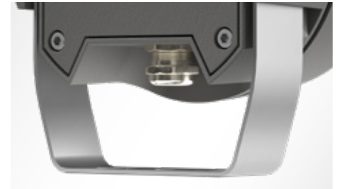
Scheurbestendige kabelklem in vernikkeld messing M20x1.5 voor kabels van Ø 10 mm tot Ø 14 mm
